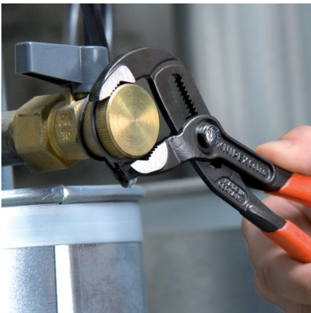
Tænder, som er forskudt mod omdrejningsretningen, giver en selvklemmende effekt og forhindrer udskridning på arbejdsområdet.
